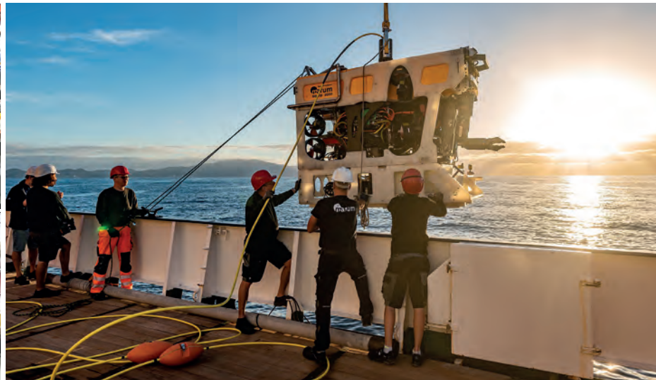
Launching the ROV from the research ship Meteor ©MARUM – Zentrum für Marine Umweltwissenschaften, Universität Bremen
